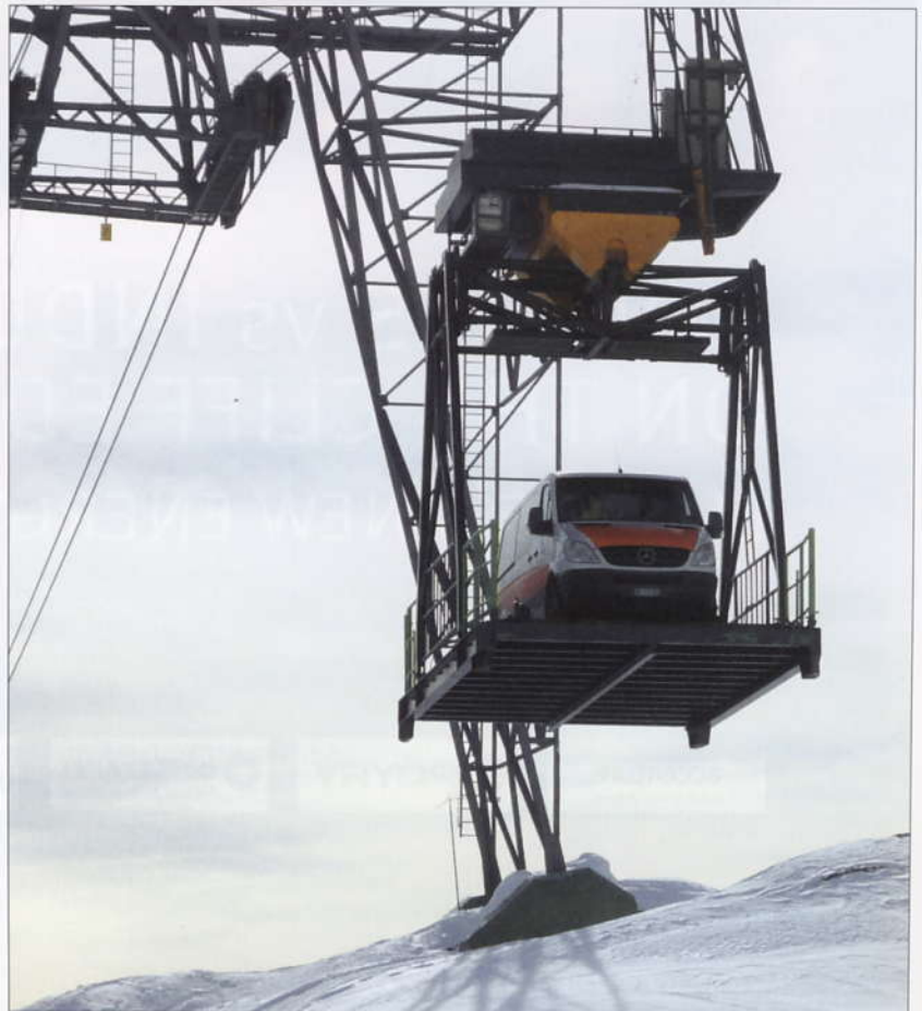
Bild 1. Mit der Seilbahn auf dem Weg zur Arbeit: Der Kabelmesswagen soll an der Schaltstation des Kraftwerks Robiei zum Einsatz kommen, um die einwandfreie Reparatur eines 16-kV-Kabels zu bestätigen
